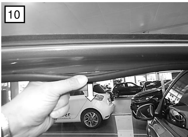
Fenstergummi abziehen / remove the window rubber
